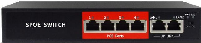
Der JVS-S06-4P-65W 100 Mbit/s Standard PoE Switch bietet Ihnen 6 adaptive 10/100M RJ45-Ports. Die Ports 1 bis 4 verfügen über eine PoE-Stromversorgung. Alle PoE-Ports können Geräte die über IEEE802.3at/af Standards verfügen automatisch erkennen und gegebenenfalls mit Strom über die Netzwerkleiste versorgt. Der Switch unterstützt außerdem den Switch Modus (VLAN Isolation). Dieser kann Leistungen bis 150m übertragen. Des Weiteren besitzt der Switch zwei wählbare Modi.
