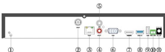
1. Schutzerdung 2. Video-Ausgang 3. RJ45 4. Audio-Ausgang
